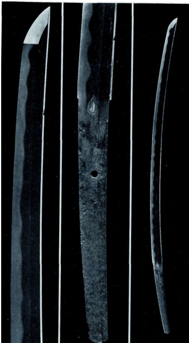
Масамунэ, тати «Исида Масамунэ», без подписи. На обухе видны боевые повреждения, в районе муфты хабаки — дефект кузнечной сварки
