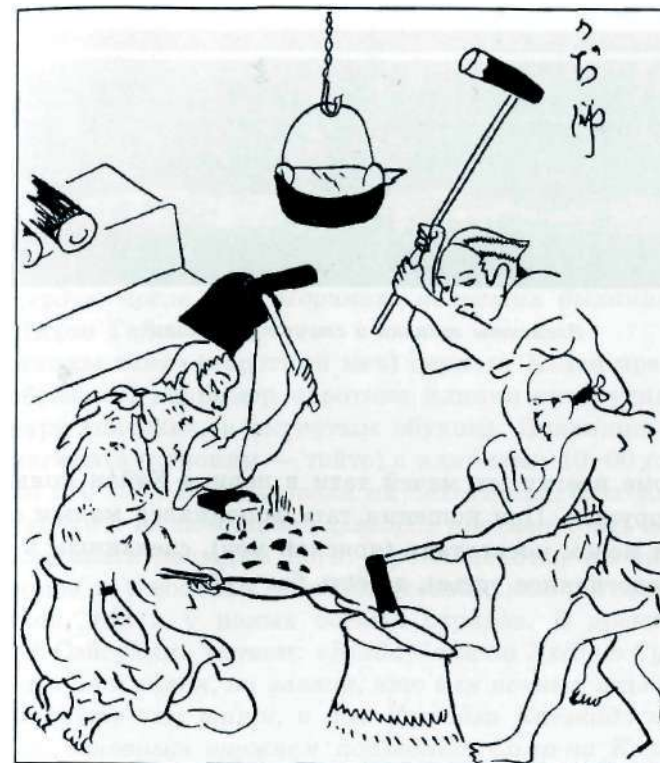
Кузнецы за работой. Мастеру помогают два молотобойца, количество которых может достигать до четырех
