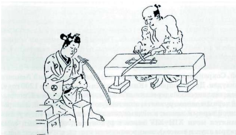
Шлифовщики мечей за работой. Ближний к нам рихтует клинок легким медным молоточком, другой совершает доводочные операции
